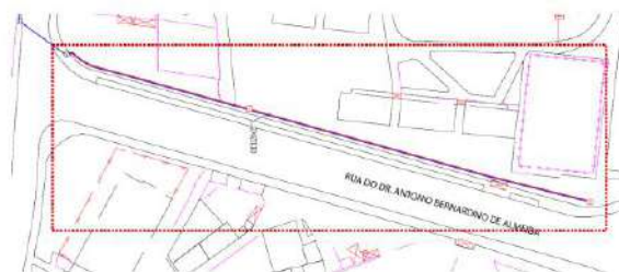
Figura 20 – Passagem de Fibra até a localização do contentor de baterias
